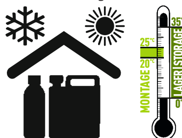
Abb. 7: Lagerung und Verarbeitung Muffenschaum
