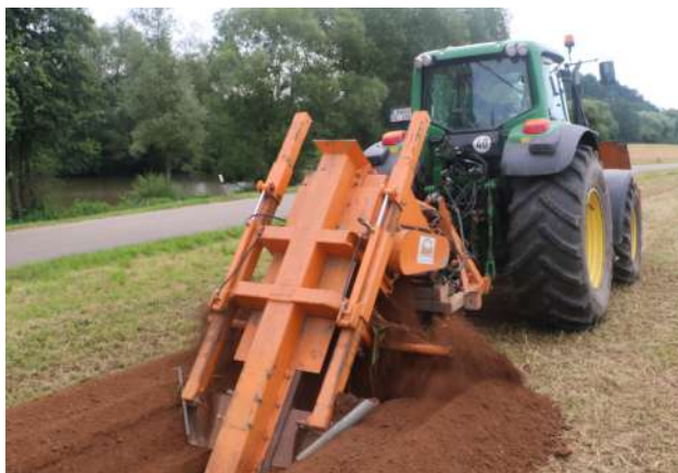
Abb. 28: Fräse ohne Einbaukasten
